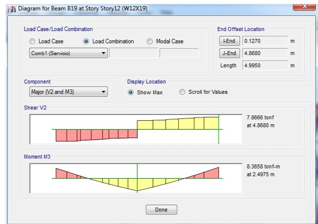
Fig. 103 Obtención del momento máximo de servicio
