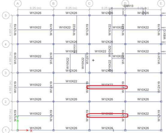
Fig. 94 Secciones de vigas principales y secundarias entrepiso 12
