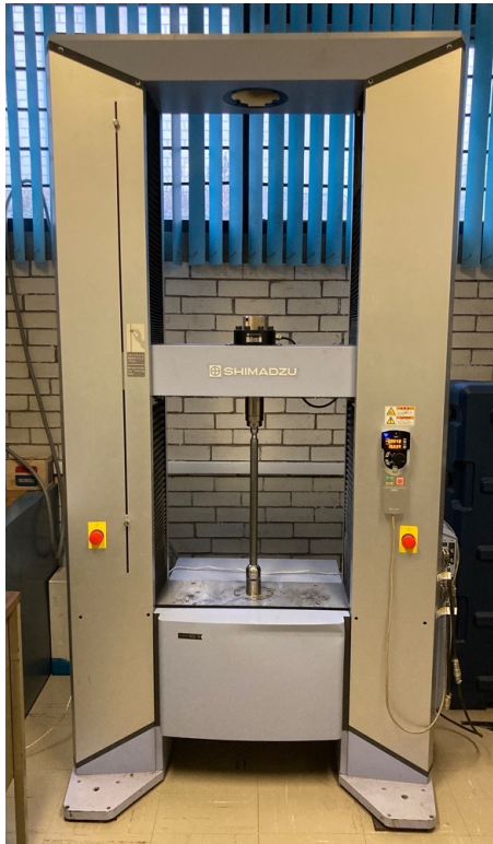
Figura 24. Modelo de pruebas montado en la máquina de pruebas universales Shimadzu AG-X
