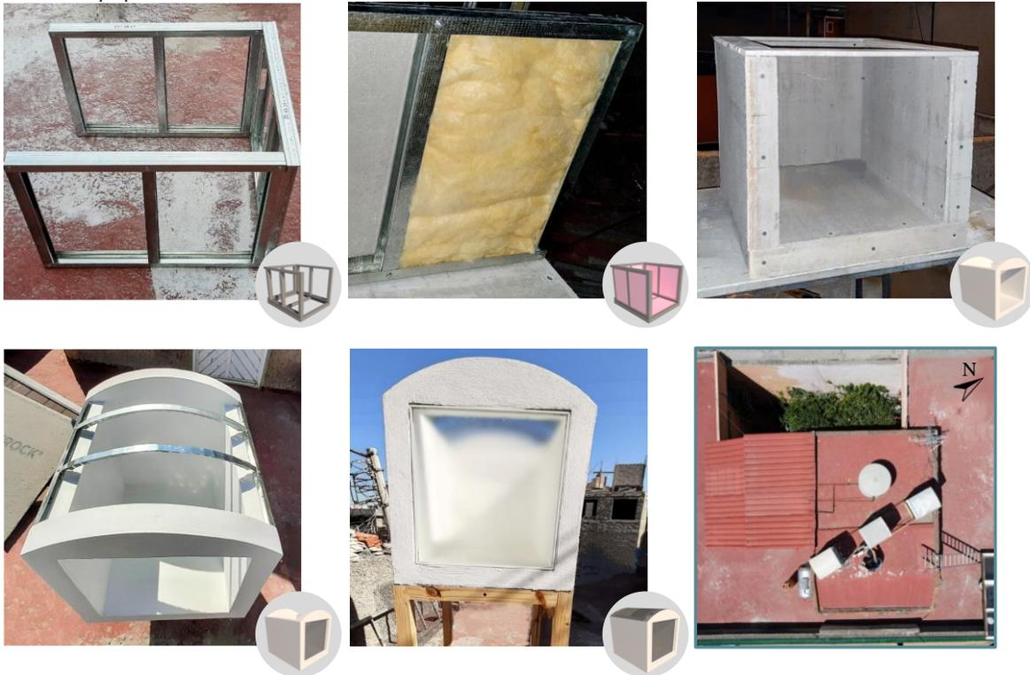
*Figura 30.* Procesos de construcción de los módulos de prueba.
