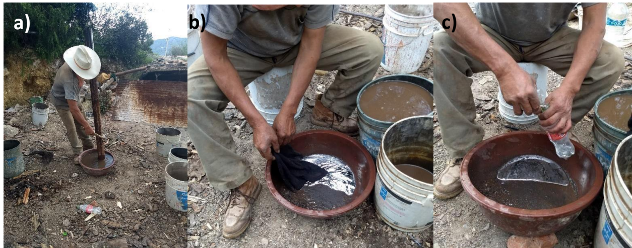
Figura 29. a) desprendimiento del mercurio líquido de los niples, b) eliminación de agua y basuras del mercurio líquido y c) envasado del mercurio. Foto por María Isidra Sánchez Monroy.
