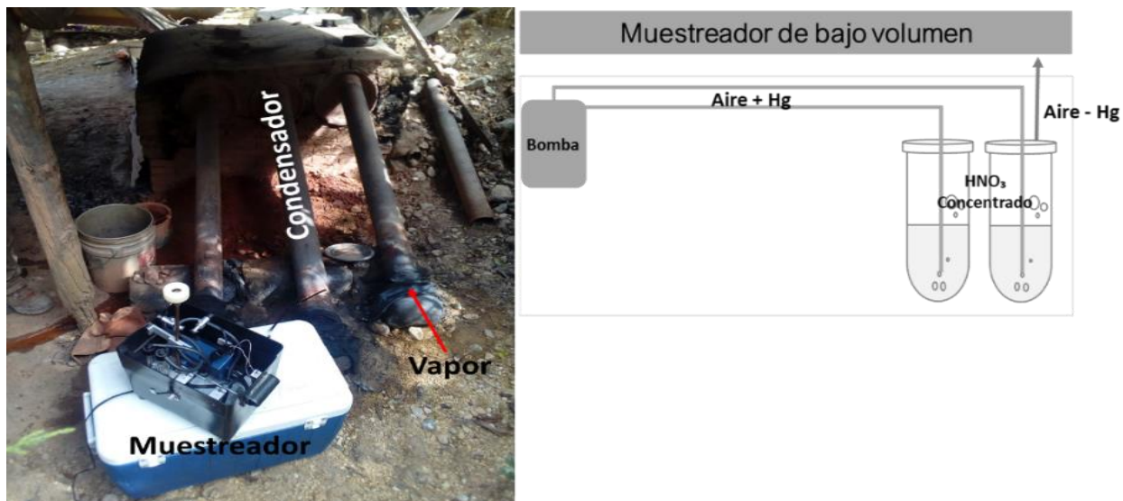
Figura 10. Condensador artesanal y esquema del funcionamiento del muestreador de bajo volumen para obtener las muestras de vapor de mercurio. Foto por María Isidra Sánchez Monroy.
