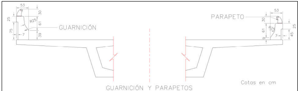
Figura 5.8 Sección transversal de las guarniciones y parapetos
