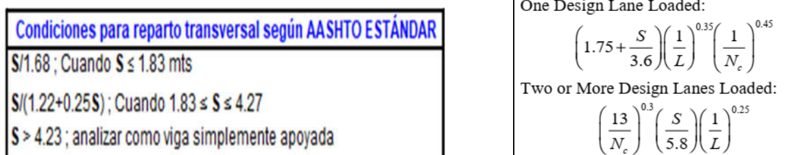
Figura 5.1 Factores de reparto transversal según AASHTO Estándar y LRFD
