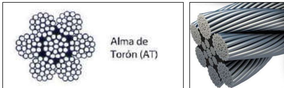
Figura 2.13 Sección transversal de un cable de presfuerzo
