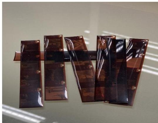
**Fig. 2.20 Cinta para película fabricada a partir del celuloide (Elaboración propia)**
