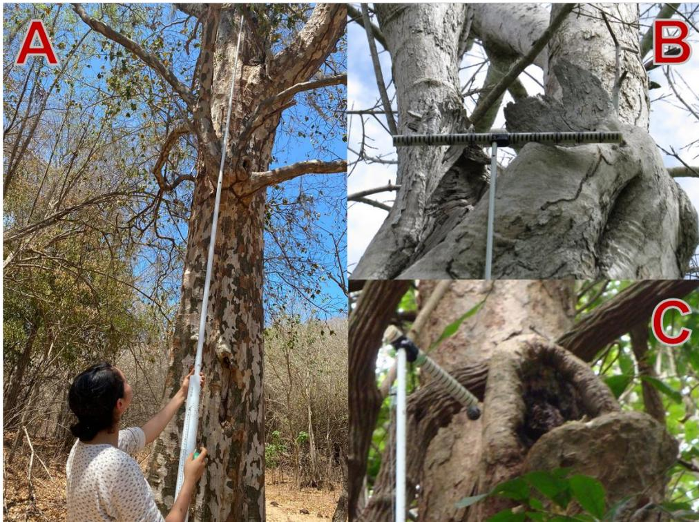
**Figura 1.** A) Medición de altura con tubo de medición de árboles extensible a 15 m. B) Medición de ancho de entrada de la cavidad y su diámetro de soporte con un tubo de PVC graduado. C) Medición de profundidad con un plomo. (Foto: Katherine Renton)
