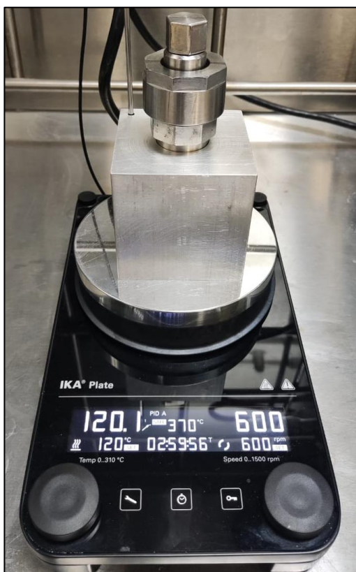
Figura 26. Sistema montado para la catálisis de nitroarilos.
