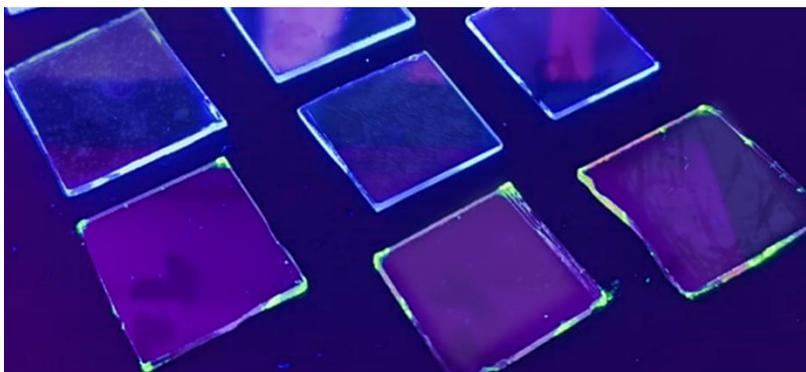
*Figura 62. Algunas películas obtenidas para PVK durante las pruebas de depósito*
