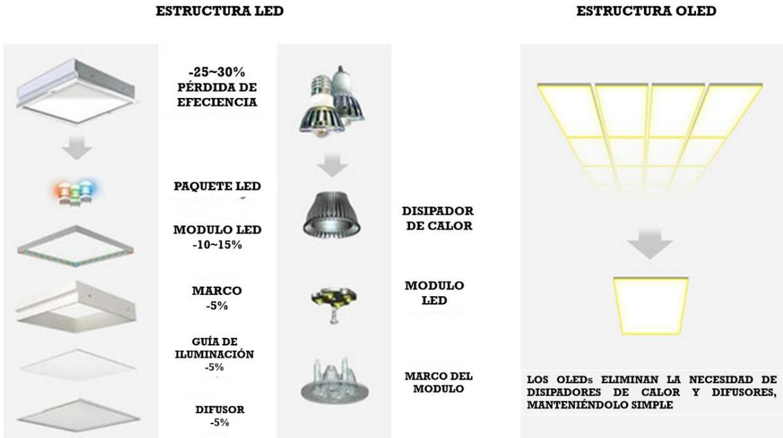
Figura 5. Esquemas de la distribución de luz LED y OLED <sup>30</sup>
