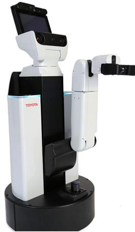
Figura 1.2: Robot HSR de Toyota utilizado en las pruebas.
