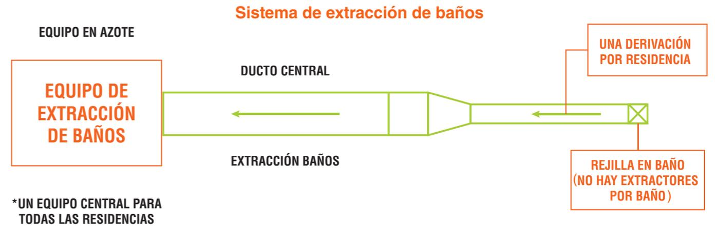
Imagen 10.22 Esquema de funcionamiento del sistema de extracción de baños.
