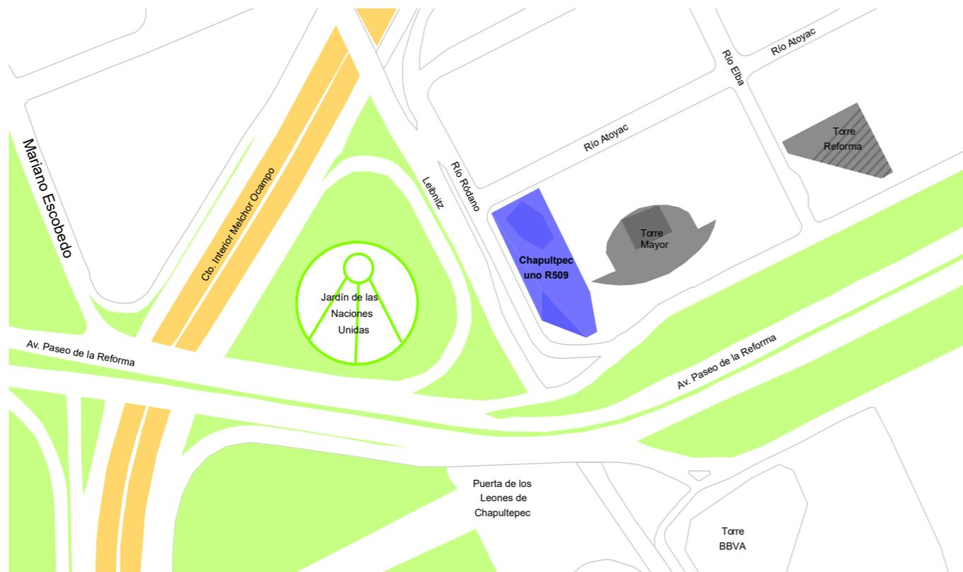
Imagen 6.0 La ubicación del edificio nos limitó a recibir embarques únicamente por la calle de Río Ródano para evitar obstruir Paseo de la Reforma en todo momento.
