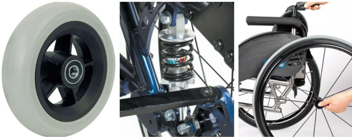
Figura 122 Rueda ancha, amortiguador y sistema de desmontaje rápido de ruedas como posibles aplicaciones para el segundo simulador.
