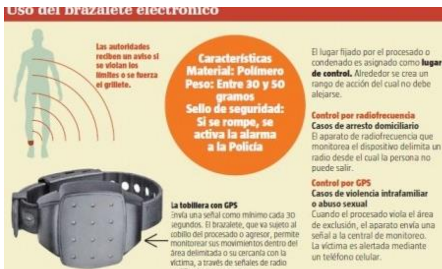
Gráfico 10. Modelo de Brazaletes Electrónico Usado
