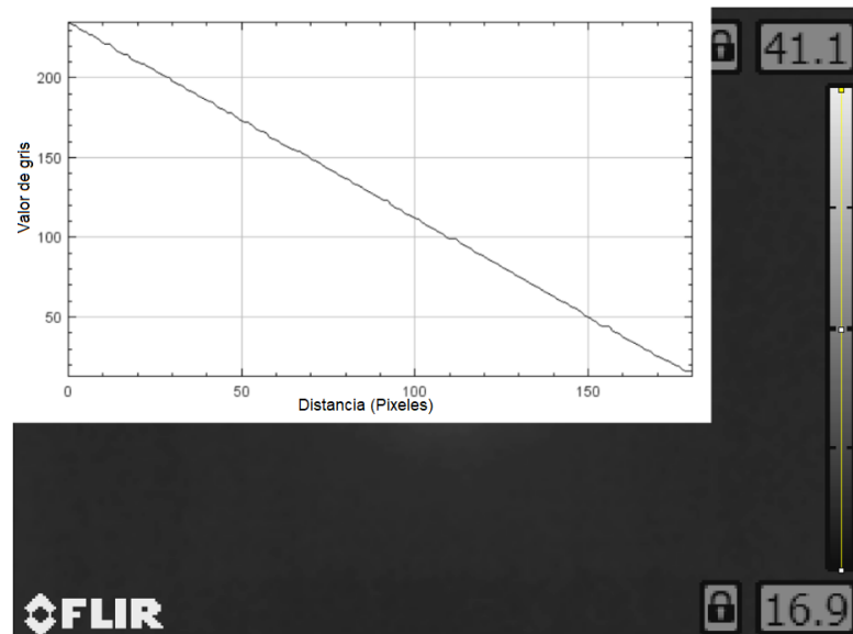
Figura 5.9: Evaluación de la escala de temperatura en función de la intensidad de píxel. Aquí, se muestra el procedimiento empleado para definir la razón de cambio o pendiente ( m ) del modelo ilustrado en la ecuación (5.9).
