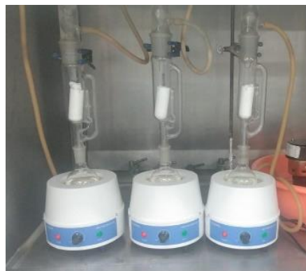
Figura 26. Equipo Soxhlet para extracción de grasas.
