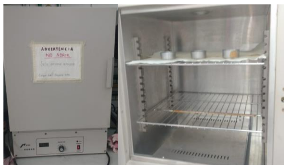
Figura 25. Estufa para la determinación de humedad.
