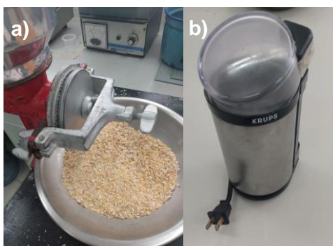
Figura 15. a) Molino manual y b) Molino de café.
