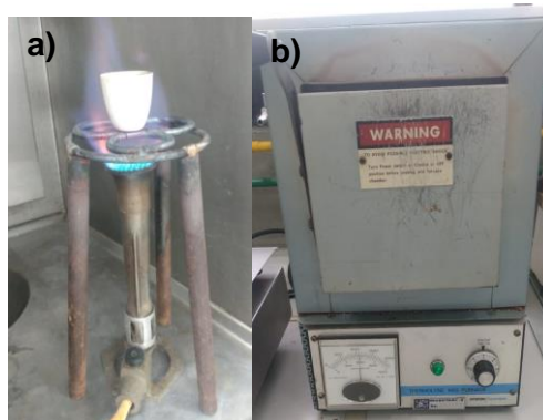
Figura 27. a) Incineración en Crisol y b) Mufla Sybron.
