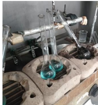
Figura 33. Determinación de nitrógeno total por micro Kjeldahl.
