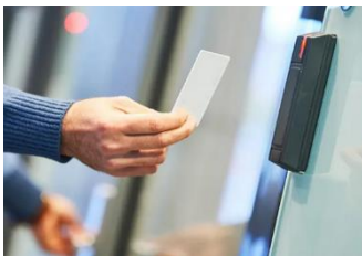
Ilustración 31 Sistema con reconocimiento de una tarjeta con chip. Nótese la ausencia de código de barras o banda en la tarjeta.
