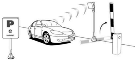
Ilustración 34 Control de acceso vehicular por medio de tag.
