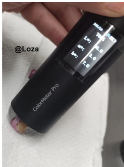
Figura 20 El colorímetro debe colocarse cerca de la muestra (fuente directa).
