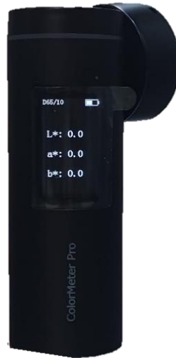
Figura 7 Colorímetro, Color Meter Pro utilizado para resultados de color (fuente directa).
