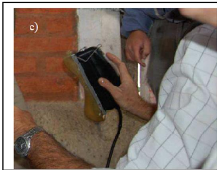
Figura 2. Transductor lineal con acoplador acústico (stand off). Cesa et al. , (2010).
