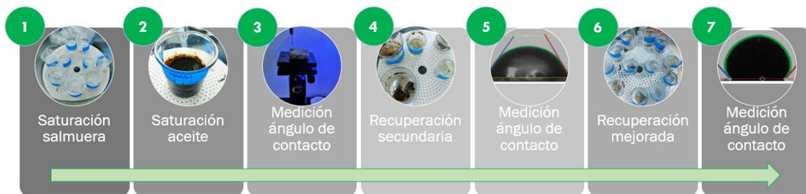
Figura 20: Metodología de prueba de ángulo de contacto
