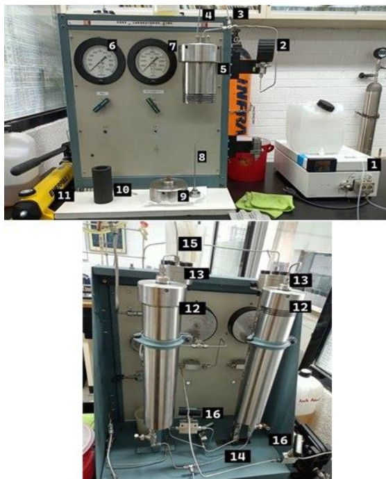
Figura 17. Componentes de la celda de desplazamiento. Parte delantera, arriba: (1) bomba de doble pistón (HPLC P40 Knauer), (2) manómetro conectado a la línea de flujo del fluido de trabajo, (3) línea de flujo del fluido de trabajo, (4) línea de flujo de un segundo fluido de trabajo 3 , (5) celda donde se ingresa la muestra, (6) (7) manómetros 4 , (8) línea de salida del fluido de trabajo, (9) cabezal ranurado, (10) manga de hule, (11) bomba de confinamiento (bomba manual). Parte trasera, debajo: (12) cilindros de almacenamiento de fluido de trabajo de capacidad de 1000 [mL], (13) filtros que impiden el paso de sólidos, (14) línea de flujo de aceite hidráulico, (15) línea de flujo del fluido de trabajo, (16) válvulas que permiten cerrar/abrir las líneas.
