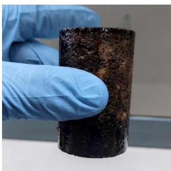
Figura 21: Núcleo después de añejamiento en celda
