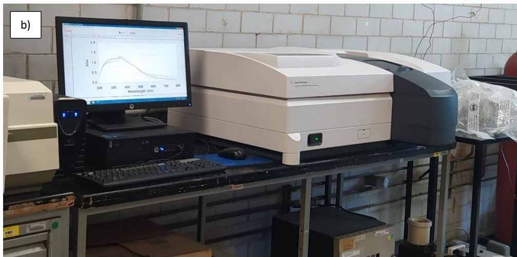
Figura 35. a) sistema óptico de un espectrofotómetro y b) espectrofotómetro UV-Vis-NIR.
