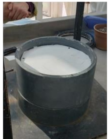
Fotografía 9. Base de columna con membrana y arenilla
