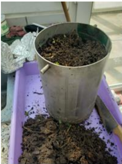
Fotografía 7. Columna de acero con suelo intacto
