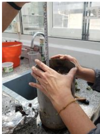
Fotografía 8. Nivelación de parte superior de columna
