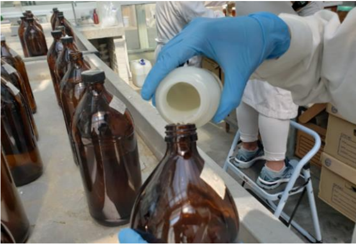
Fotografía 16. Toma de muestras para paso de lixiviados por cartuchos
