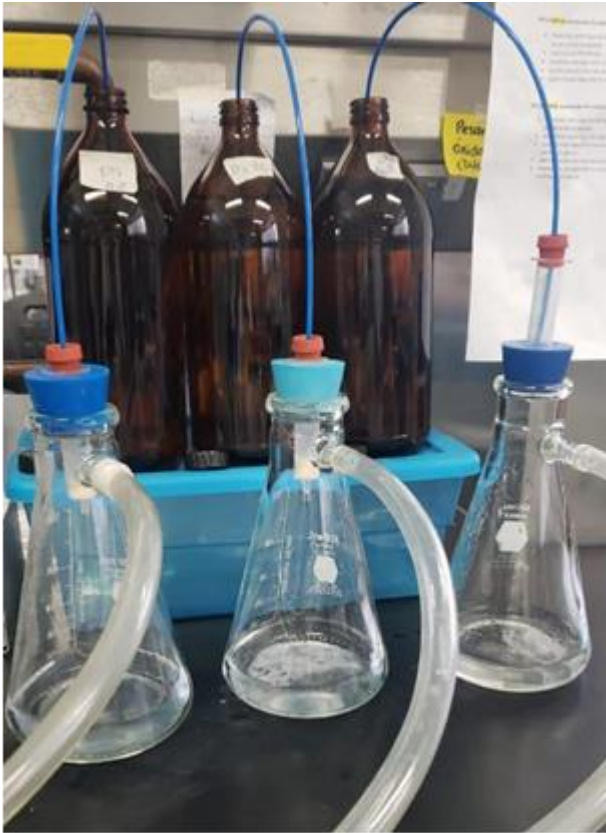
Fotografía 18. Filtrado de muestras por cartucho
