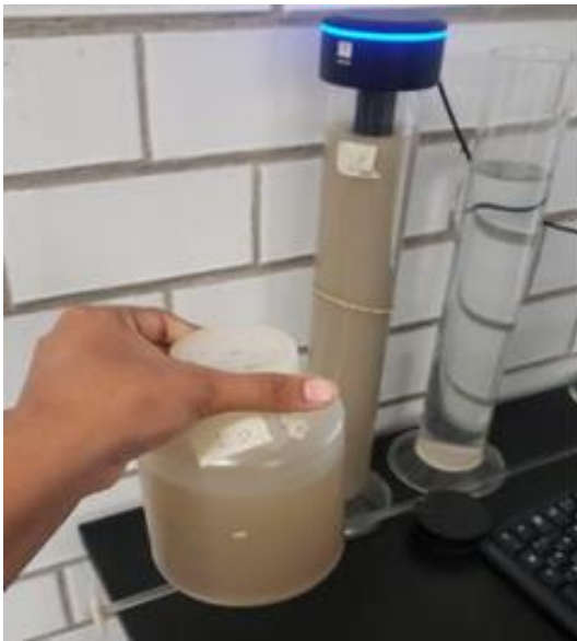
Fotografía 5. Muestra de suelo en el sistema de lectura PARIO
