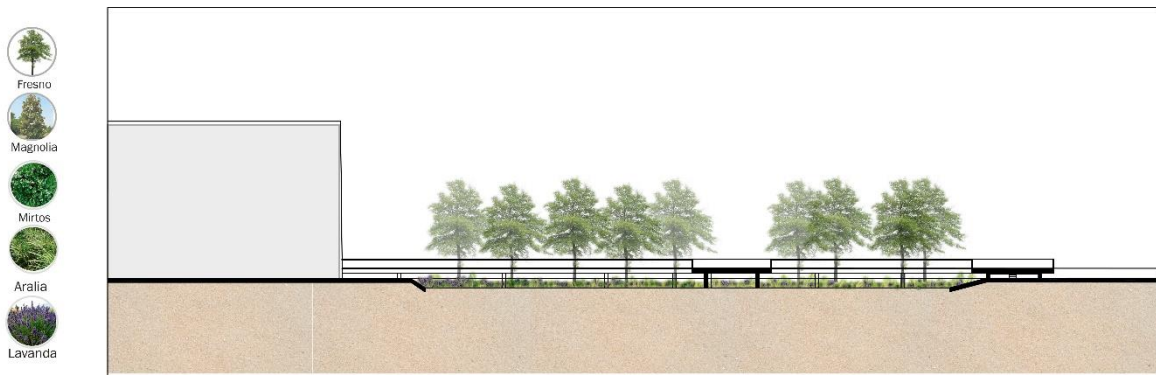
CORTE TRANSVERSAL JARDÍN DE BIORETENCIÓN
