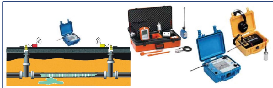
Figura 8 Correlador localizador de fugas. (MAPAS)
