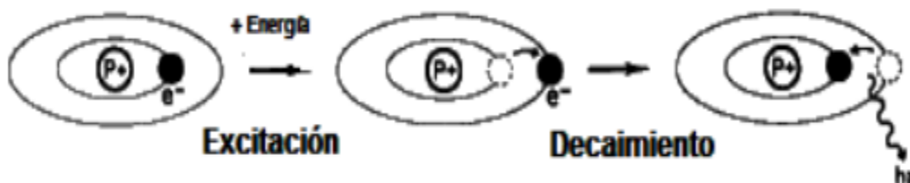
Figura 6. Esquema del modelo atómico de Bohr. Al absorber energía el átomo, un electrón se excita a un orbital de un nivel de mayor energía o estado excitado que es menos estable. El átomo puede decaer a un estado de menor energía produciendo un fotón, h\nu .
