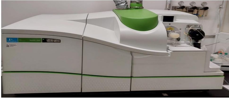
Figura 12. Espectrómetro de masas con plasma acoplado inductivamente del departamento de toxicología del CINVESTAV-IPN.
