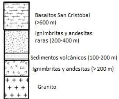
Imagen 5 Columna estratigráfica regional propuesta para Los Altos de Jalisco, modificado de Rossotti et al. , 2002.
