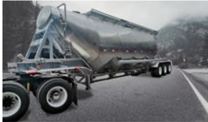
Tolva para transporte de arena sílica, semillas, granos, cementos, cal y productos a granel.
