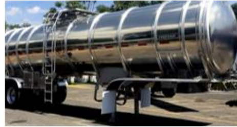
Autotanque para transporte de materiales y residuos peligrosos, en forma líquida o de gas
