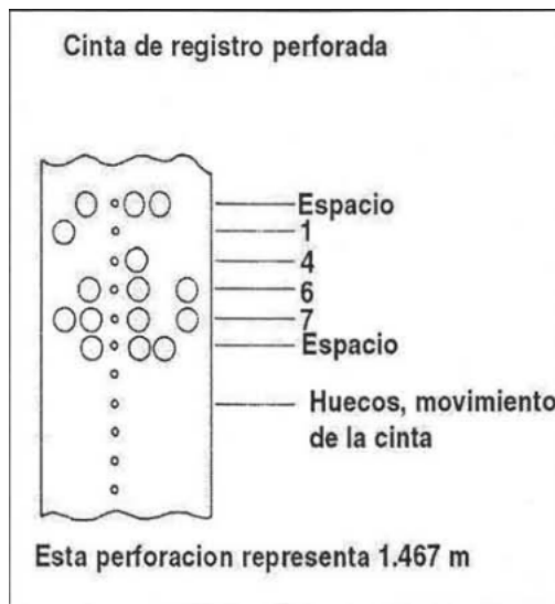
Figura B.2: Esquema general del registro del mareógrafo de flotador con cinta perforada.
