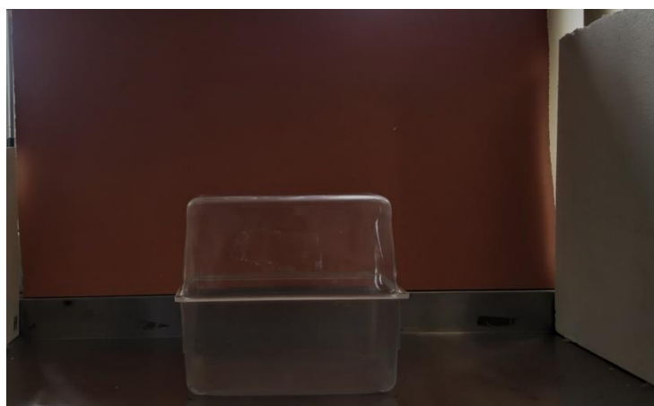
Imagen 44.- Ejemplo de montaje y colocación de la arena neutral en el lugar de evaluación. El lugar preciso donde se coloca la caja debe ser marcado para evitar modificaciones con cada maniobra.
