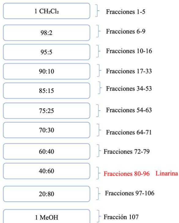
**Figura 14.** Fraccionamiento del extracto metanólico de hojas de *B. cordata* mediante CC, fase normal. El fraccionamiento inició con una fase móvil 100 % CH<sub>2</sub>Cl<sub>2</sub>, de forma subsecuente se incrementó la polaridad con MeOH hasta llegar a una fase móvil de 100 % MeOH, a una polaridad de CH<sub>2</sub>Cl<sub>2</sub>-MeOH 40:60 se obtuvo linarina.
