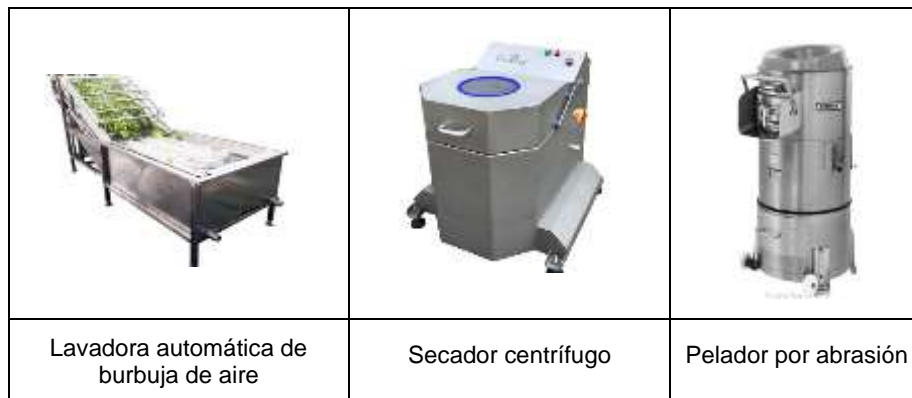
Figura 9. Ejemplos de equipo de proceso de los productos minimamente procesados (Artes & Allende, 2014; Laurila & Ahvenainen, 2002).
