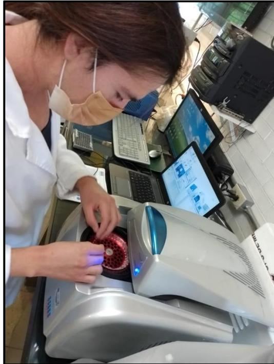
Figura 10. Termociclador para PCR en tiempo real
