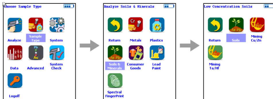
Figura 3.5. Pantalla que muestran el menú para elegir la configuración de los filtros y el tiempo para tomar los datos.
