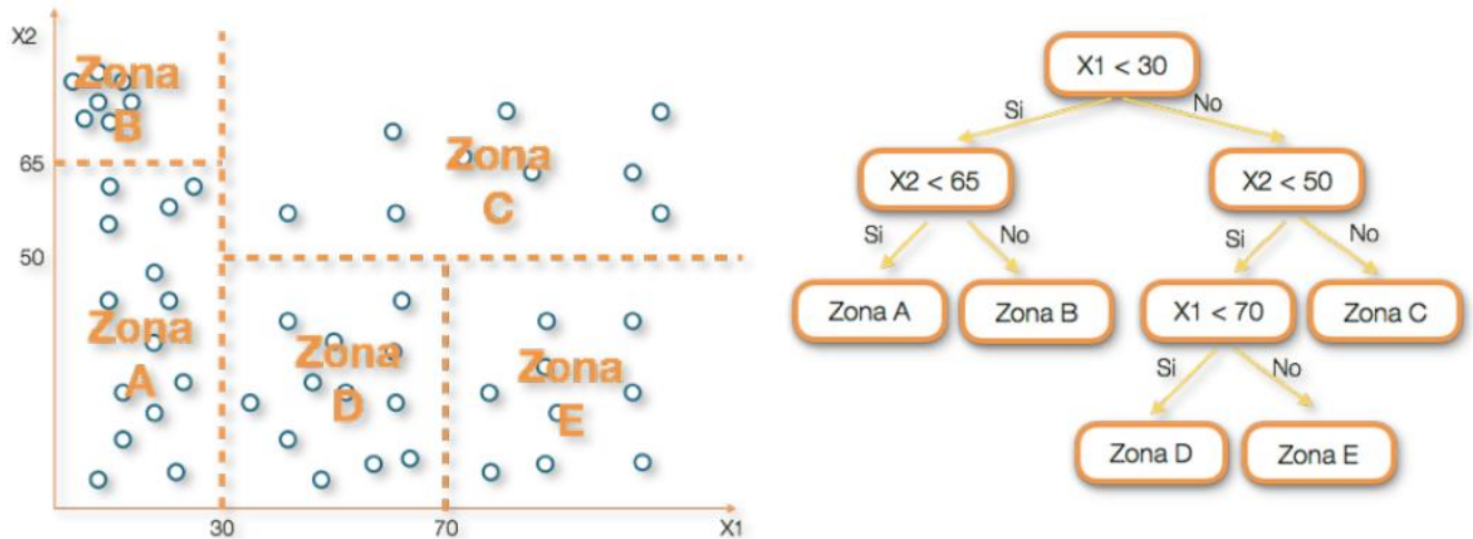
Figura 2.25. Forma gráfica del algoritmo de Decision Trees. A la izquierda se muestra la forma en que se separan los datos y en la derecha está el árbol formado con cada división.
