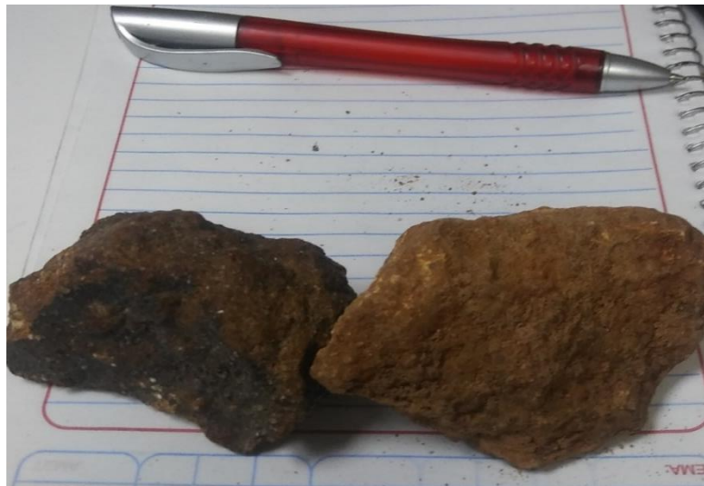
Figura 5.6. Muestra de mano correspondiente a la zona oxidada.
