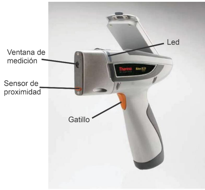
Figura 2.8. Espectrómetro Niton XL. Imagen tomada de https://portables.thermoscientific.com/ .
