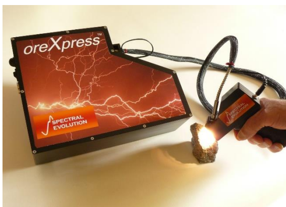
Figura 2.10. Espectrómetro OreXpress. Imagen tomada de: https://www.malvernpanalytical.com/es/products/product-range/asd-range/terraspec-range/terraspec-halo-mineral-identifier .
