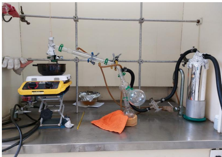
Figura 14. Montaje de la destilación a presión reducida
