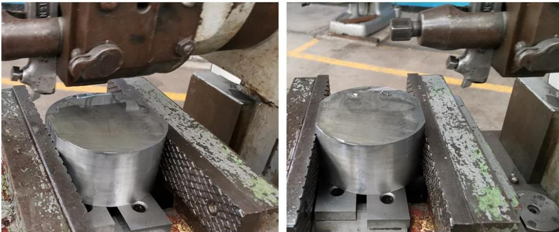
**Figura 31. Operación de careado, en máquina cepilladora.**
