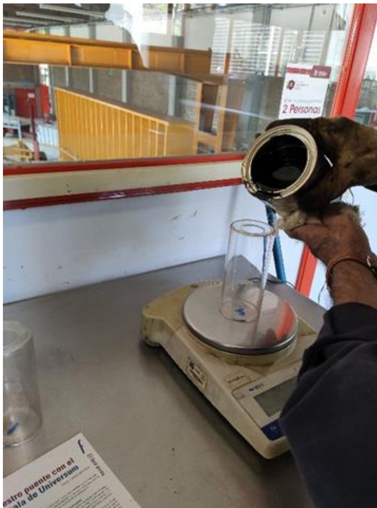
Fig. 23 Vaciado de cemento asfáltico en vasos de vidrio RTFO.
