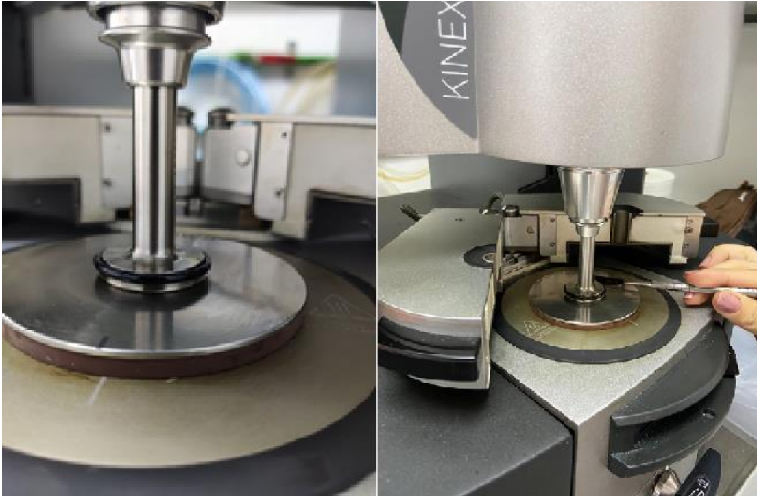
Fig. 33 Exceso de cemento asfáltico en el perímetro de las geometrías y enrasado.
