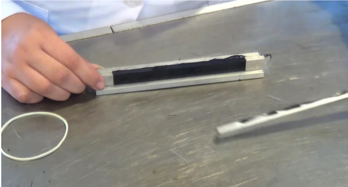
Fig. 38 Desmolde de viga.
