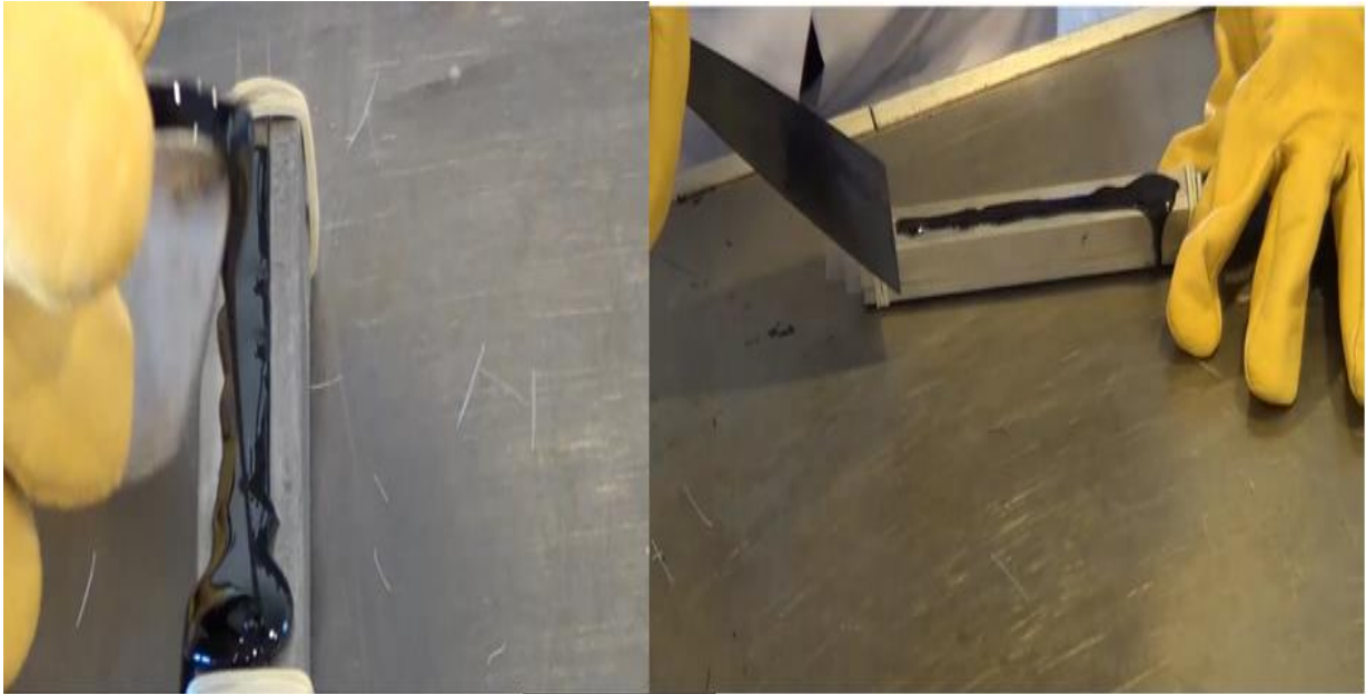
Fig. 37 Llenado de cemento asfáltico y enrase.
