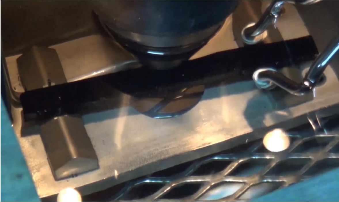
Fig. 39 Colocación de viga de cemento asfáltico sobre los apoyos.
