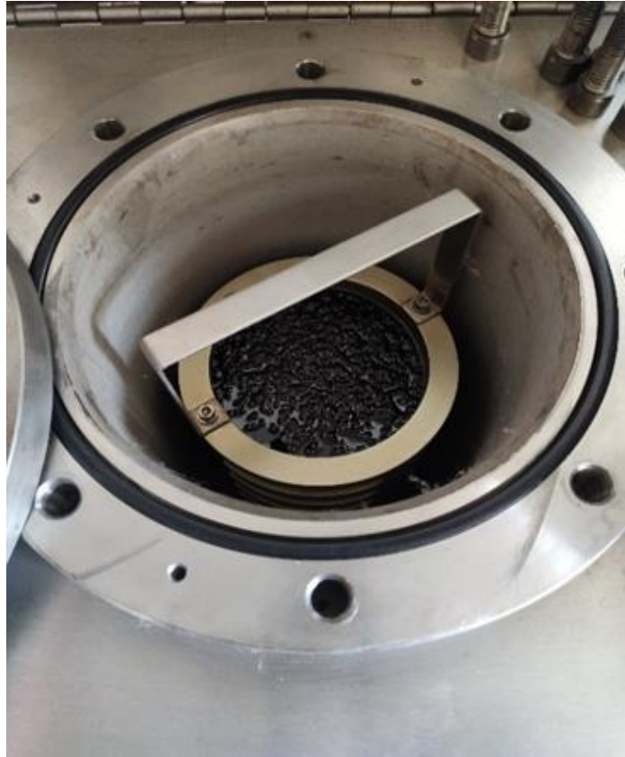
Fig. 29 Cemento asfáltico al finalizar prueba PAV.
