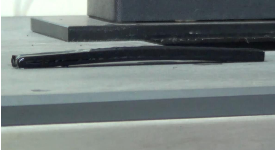
Fig. 40 Deformación de viga BBR.
