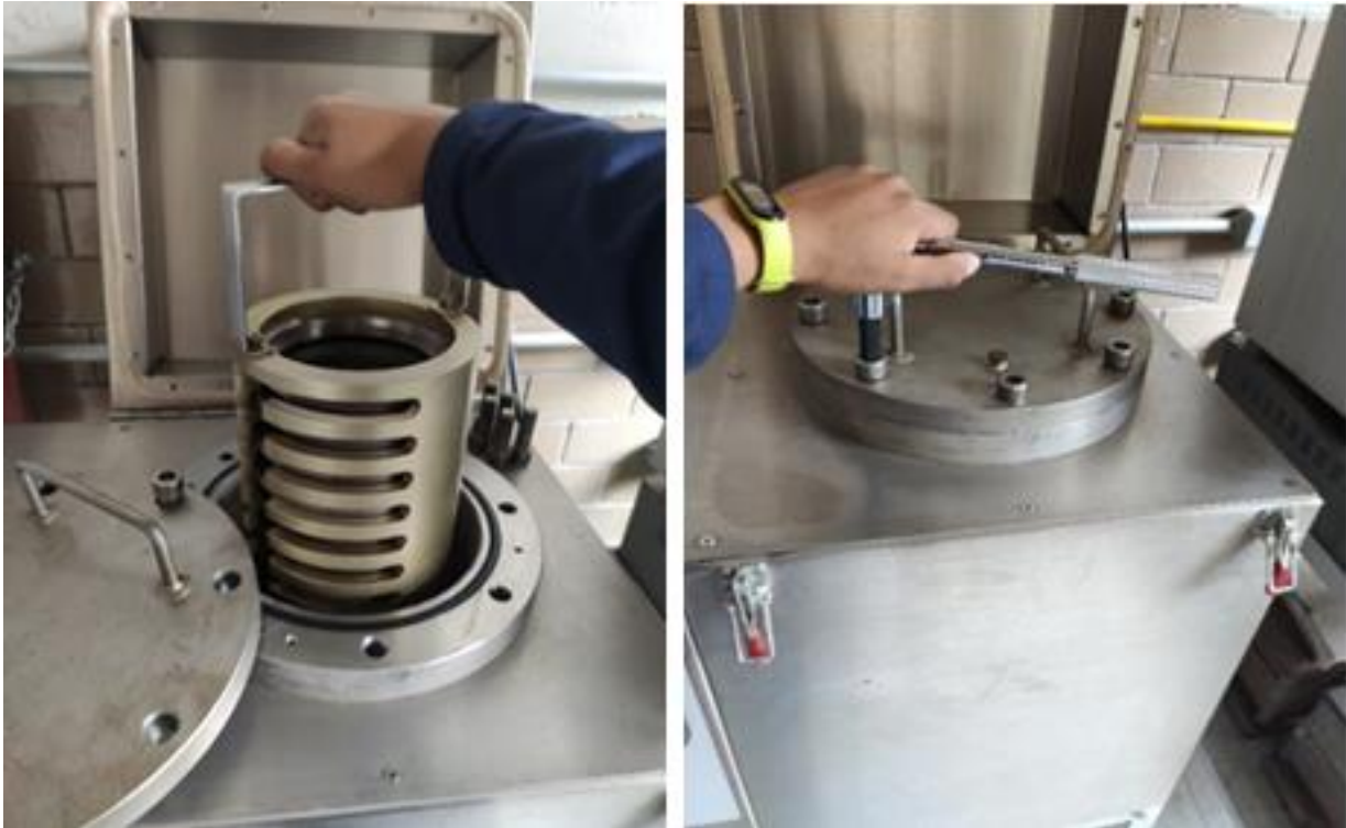
Fig. 28 Bandejas dentro del bastidor y cerrado hermético de Vasija PAV.
