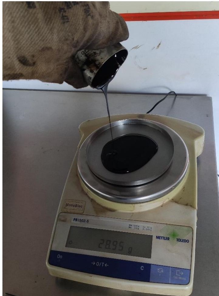
Fig. 27 Vaciado y pesado de cemento asfáltico en bandejas PAV.
