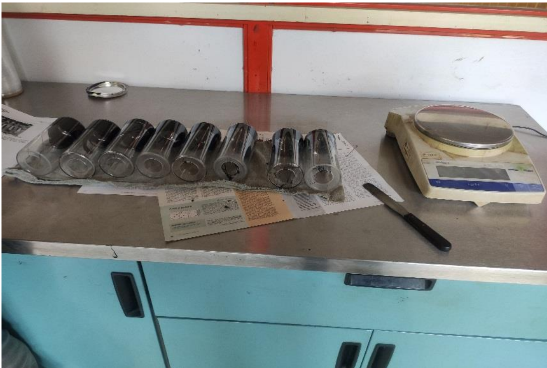
Fig. 24 Vasos en reposo después de verter el cemento asfáltico.
