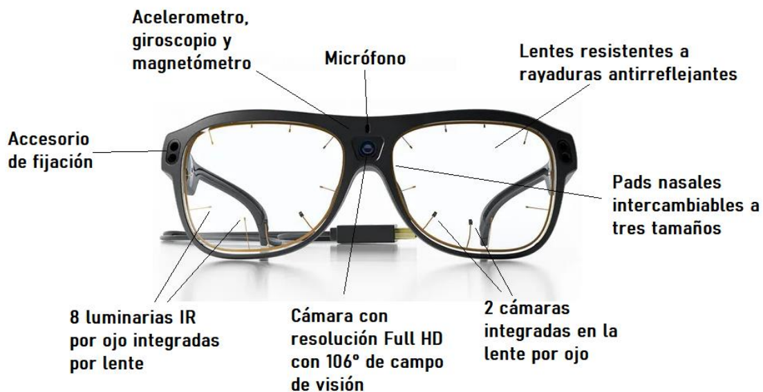
Figura 22. Vista isométrica de Tobii Pro Glasses. Se muestran los aditamentos con los que cuenta el dispositivo, tales como micrófono, acelerómetro, giroscopio, magnetómetro, dos cámaras Full HD integradas para cada lado, cojinetes nasales intercambiables a tres tamaños, ocho fuentes de luz integrada para cada ojo y mica antirreflejante, así como su un puerto USB para la carga de la batería.
