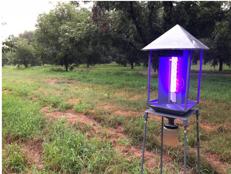
Figura 4. Trampa de luz negra con frasco colector lleno de propilenglicol establecida en plantación orgánica.
