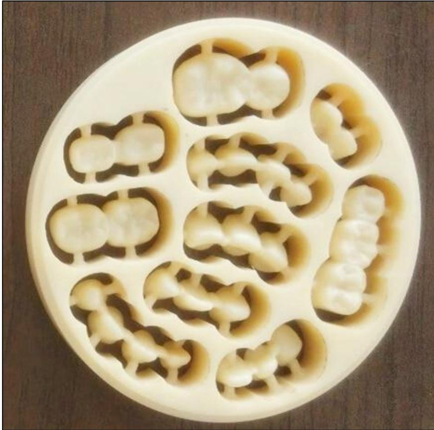
**Imagen 11.** Cad Cam Zirconia
