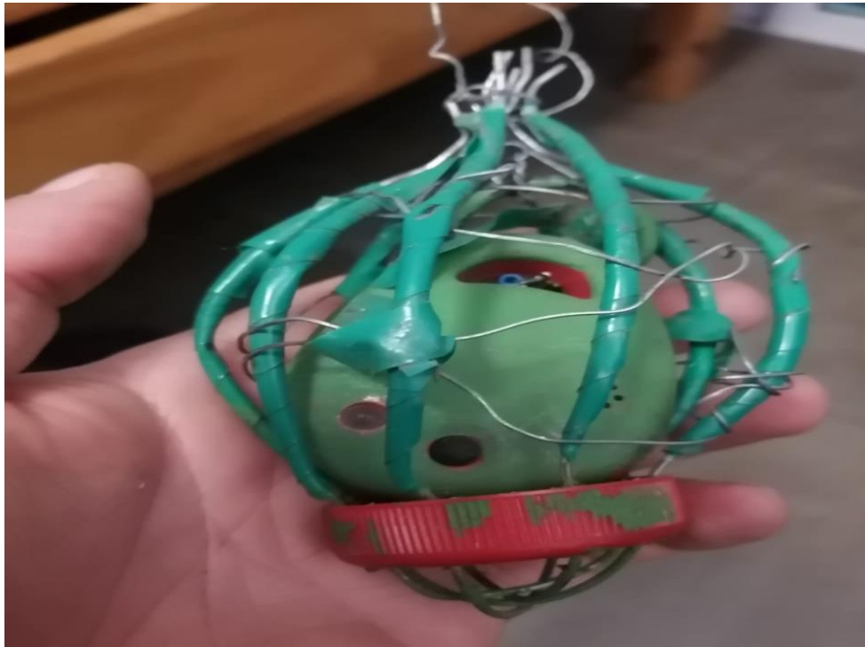
Figura 3.8. Adecuaciones de seguridad aplicadas a los sensores ambientales automáticos.
