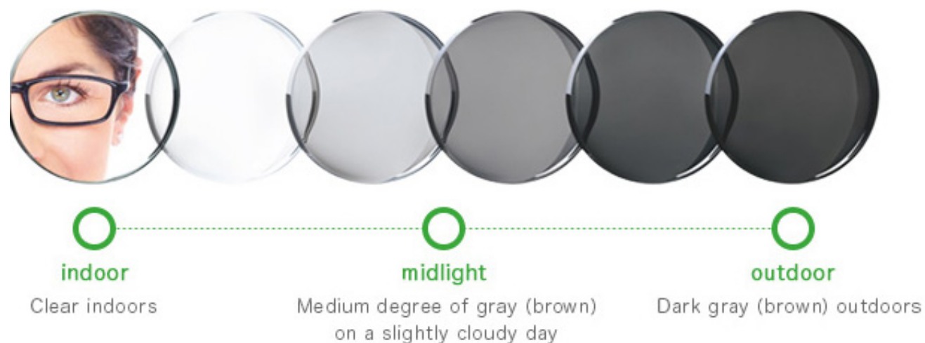
Figura 29. Esquema de funcionamiento de un lente fotocromático al estar expuesto a la radiación visible y ultravioleta de Weetect (WeeTect, 2016).
