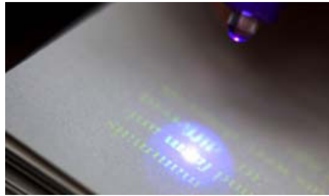
Figura 30. Tinta fotocromica, al ser expuesta a radiación Ultravioleta o visible emite un color. (Sinkrolnk, 2009).
