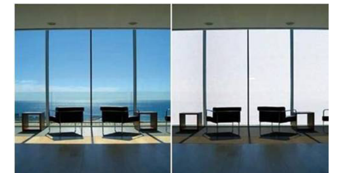
Figura 28. Uso de vidrio electrocrómico en fachadas. Cortesía de Glass App Source. https://www.findlight.net/blog/2018/02/22/smart-glass/
