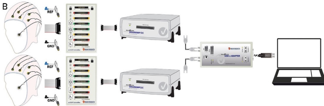
Figura 5.3 Ilustración de los elementos y conexiones en el montaje de hiperescaneo EEG con el equipo de BrainProducts e EasyCAP. Cada participante estaría conectado a un amplificador (BrainAmp DC) mediante cajas de electrodos individuales, esto permite tener una Referencia y una Tierra individuales y, por lo tanto, registros independientes. Los amplificadores estarán conectados a la computadora por un adaptador USB2. Las señales de ambos participantes serán registradas simultáneamente en un espacio de trabajo de 64 canales (BrainVision Recorder) (Barraza et al., 2019).
