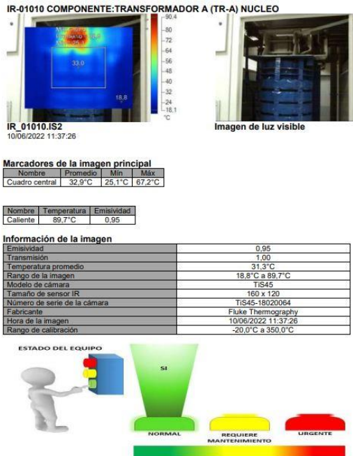
Imagen 36. Ejemplo de una termografía y los parámetros presentados por elemento, el reporte contenía alrededor de 40 termografías (propiedad del INFONAVIT)
