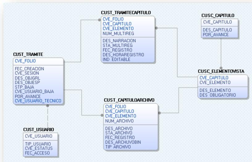
Figura 2. Modelo de datos del sistema parte uno.
