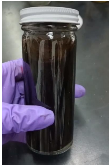
10a. Emulsión de aceite extrapesado. Agentes estabilizadores: surfactante y NPs. Día 0.
