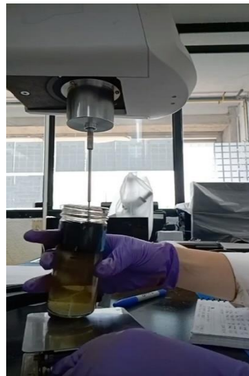
10d. Medición de viscosidad con viscosímetro Brookfield de una emulsión de aceite extrapesado. Día 7.
