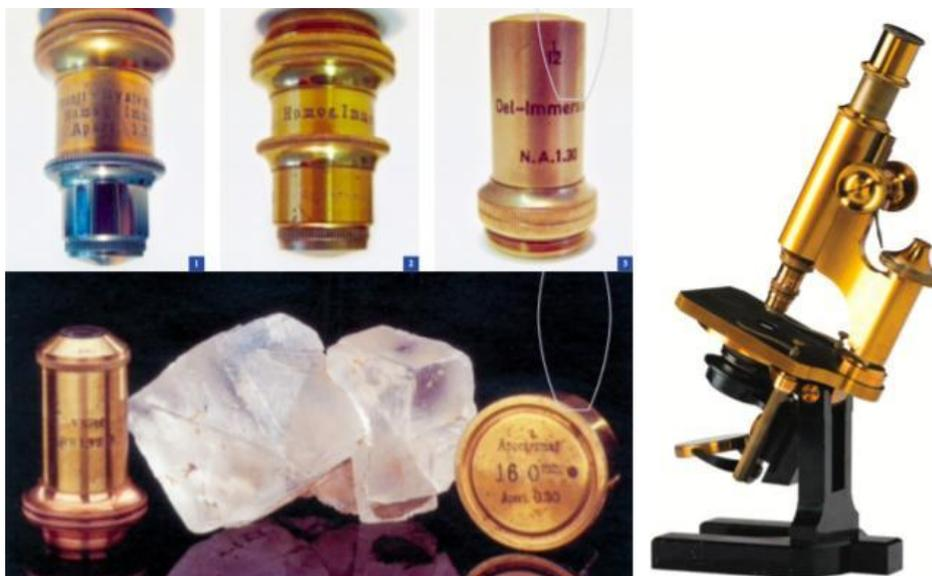
Figura 6. Aportaciones de Abbe a la microscopía óptica. En la imagen izquierda superior se muestran algunos de los primeros objetivos de inmersión. En la parte inferior muestras de fluorita natural y artificial utilizada para mejorar la calidad del vidrio de la lente. Microscopio con soporte inclinado y con sistema integrado de movimiento micrométrico, 1882. Imágenes tomadas de *Innovation 15.*, 2005; *Wimmer, 2017*
