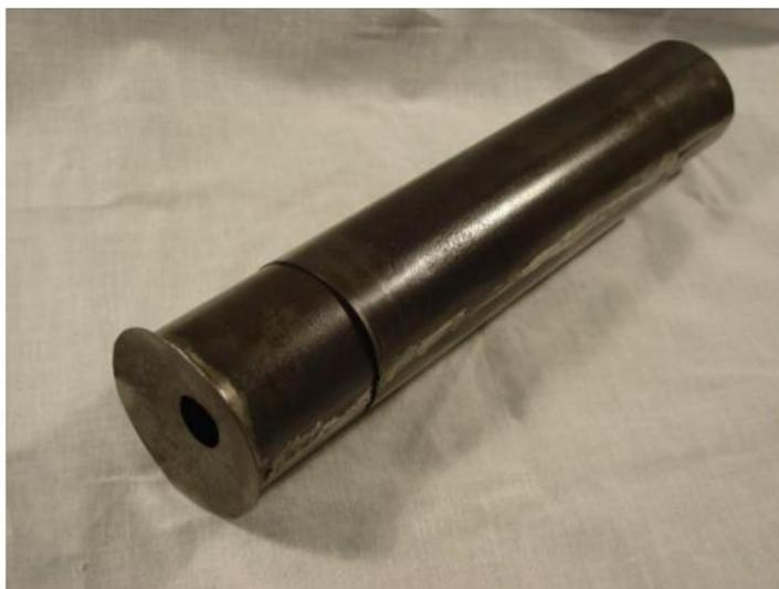
Figura 1. Microscopio de Zacharias Janssen. Es considerado el primer microscopio compuesto, fabricado en la última década del siglo XVI. Este instrumento está formado por dos cilindros de latón concéntricos, cada uno con una lente. Al mover estos cilindros se lograba enfocar la imagen aumentada de la muestra observada. Imagen de referencia tomada de internet (<https://proyectoidis.org/microscopio/>).
