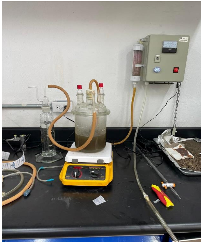
Figura 22. Sistema de ozonización.
