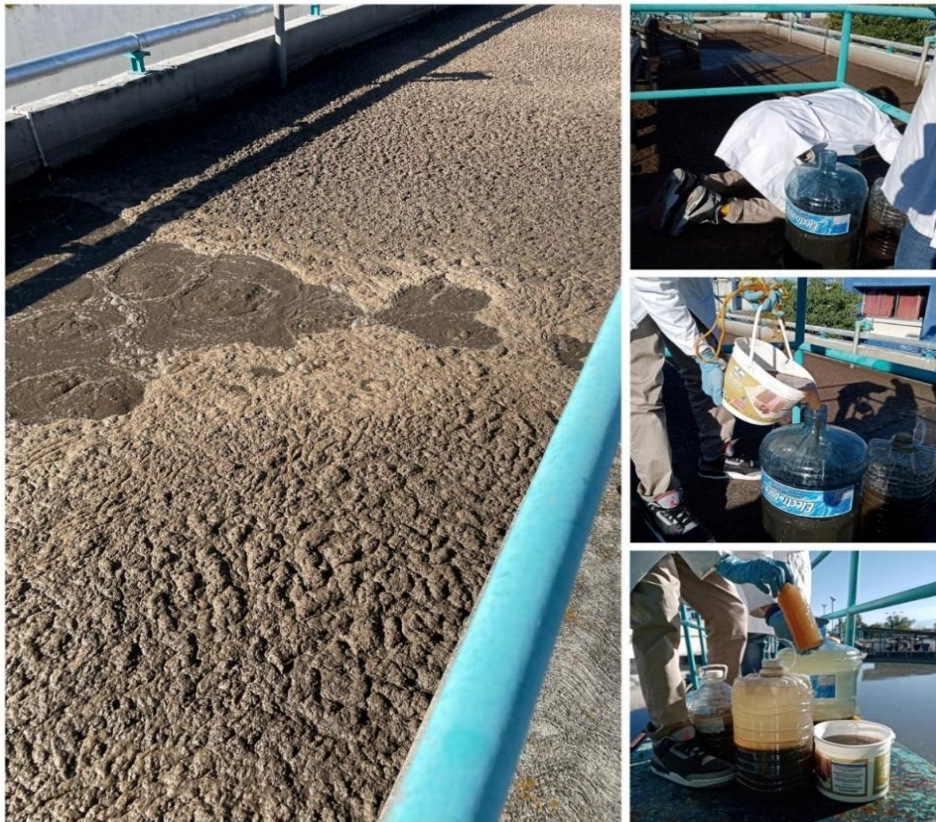
Figura 18. Muestreo en el reactor biológico.
