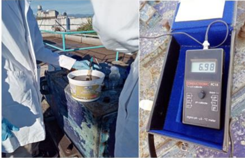
Figura 19. Medición de pH.
