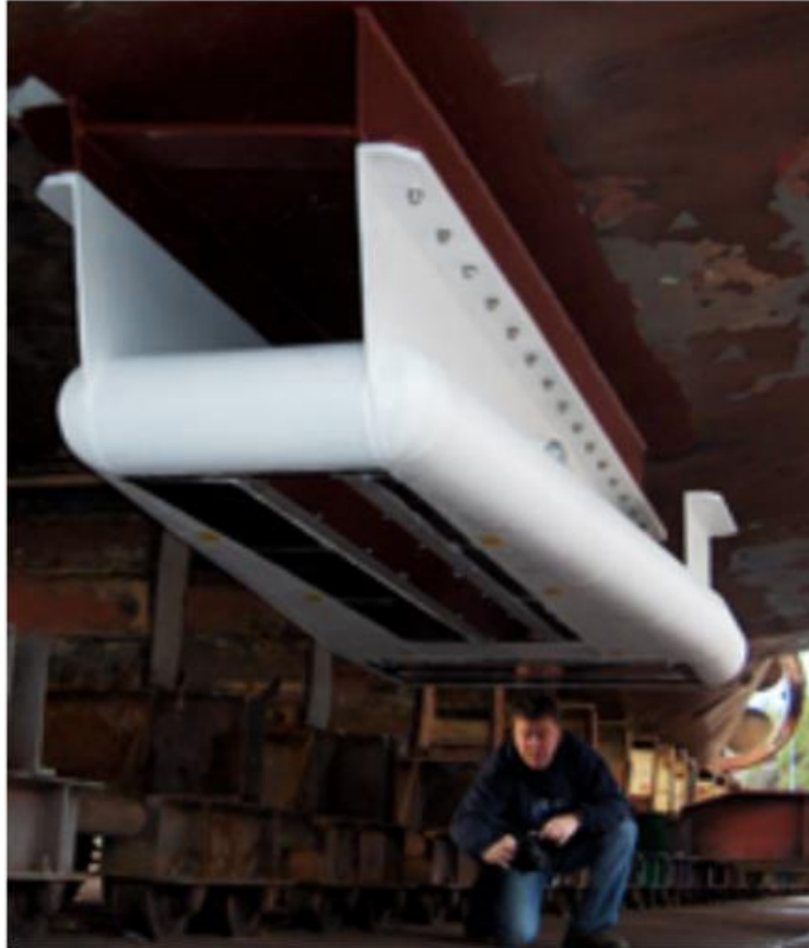
Figura 26 Góndola montada en el casco de un barco. Obtenido de (Kongsberg, 2022).
