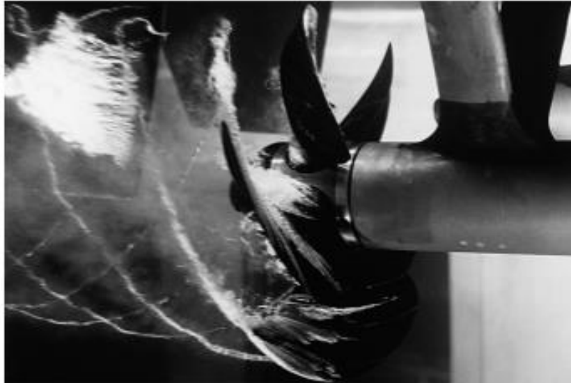
Figura 11 Ruido por cavitación. Obtenido de (Kongsberg, 2022)
