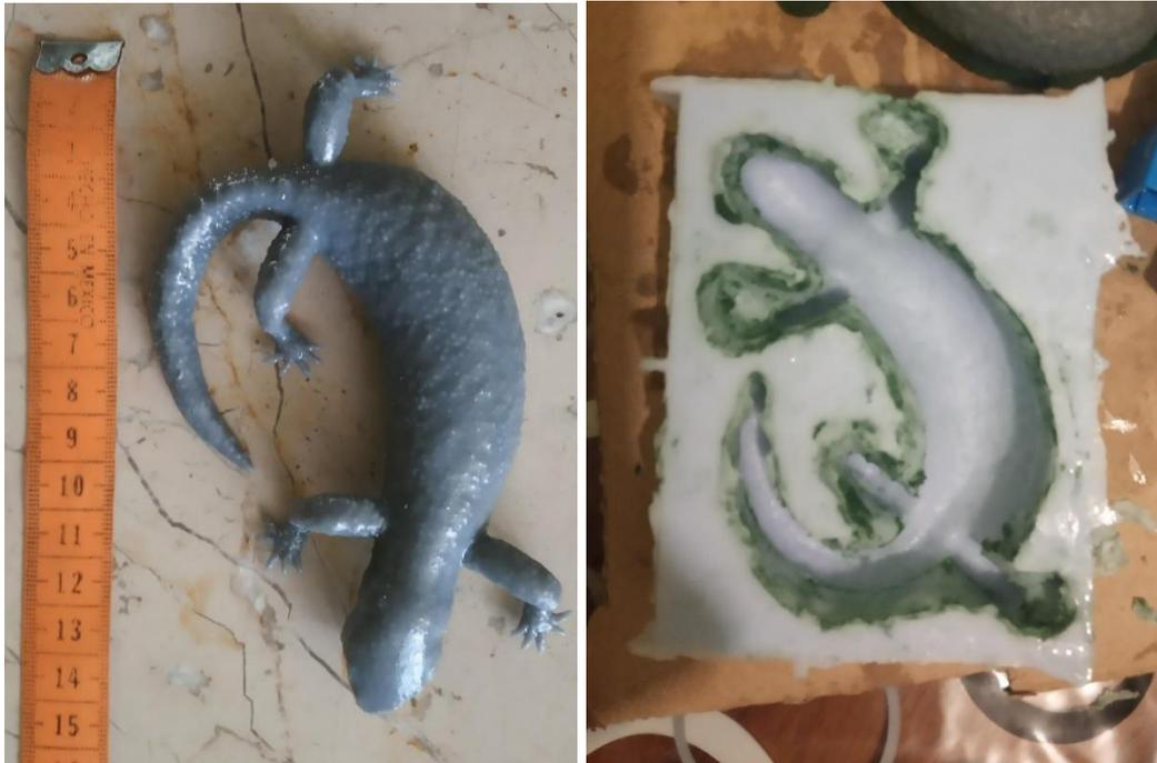
Figura 3. Modelo impreso en 3D de *Heloderma horridum* y un molde de silicona obtenido a partir de este.
