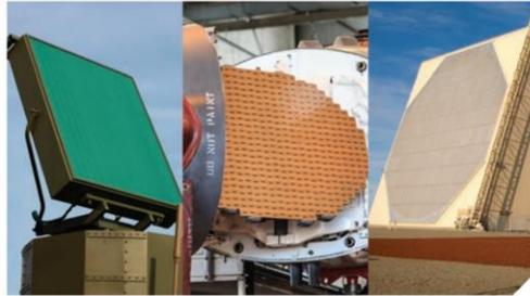
**Figura 2-4.** Fotografías de algunas antenas en arreglos de fase. Fuente: [24].
