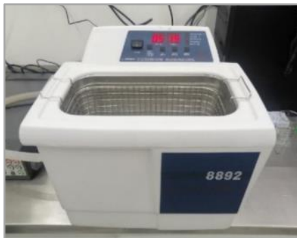
Figura 3.3. Fotografía del equipo de limpieza por ultrasonido del laboratorio de fotónica del silicio del IFUNAM.
