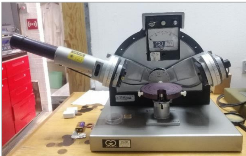
Figura 3.11. Elipsómetro de nulidad usado en esta investigación. Perteneciente al laboratorio de preparación y caracterización de películas delgadas del departamento de materia condensada y criogenia que se encuentra en el IIM de la UNAM.
